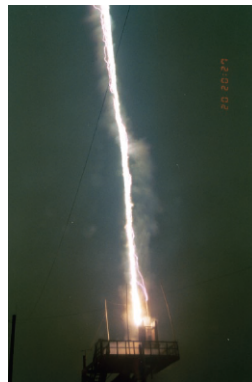
図 2.3: フロリダでのロケット誘雷実験 [8]
